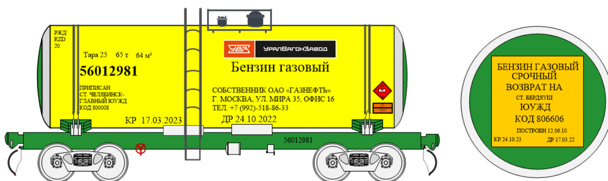
Рисунок 5 – Нанесение специальных трафаретов и знаков опасности на цистерну с бензином.
